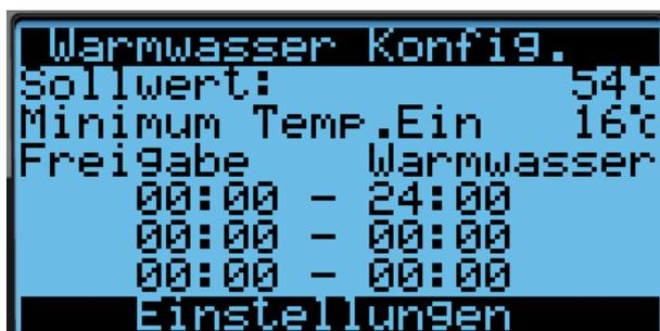
Figure5 : Exemples de réglages pour l'eau chaude sanitaire
